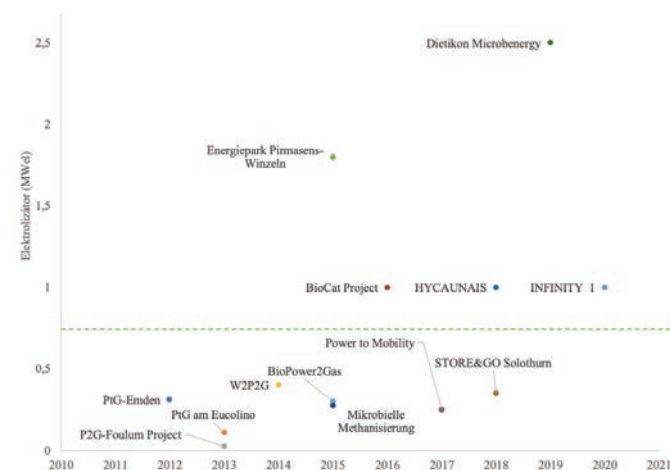
4. ábra. A lehetséges P2G üzem mérete a vizsgált szennyvíztisztító telepnél (750 kW el , szaggatott vonallal), nemzetközi kontextusban
