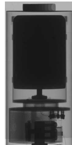
2. ábra: A minták aktivitásméréséhez felhasznált teljes energia hatásfokgörbéje (a) valamint a detektor röntgen radiográfiás felvétele (b)
