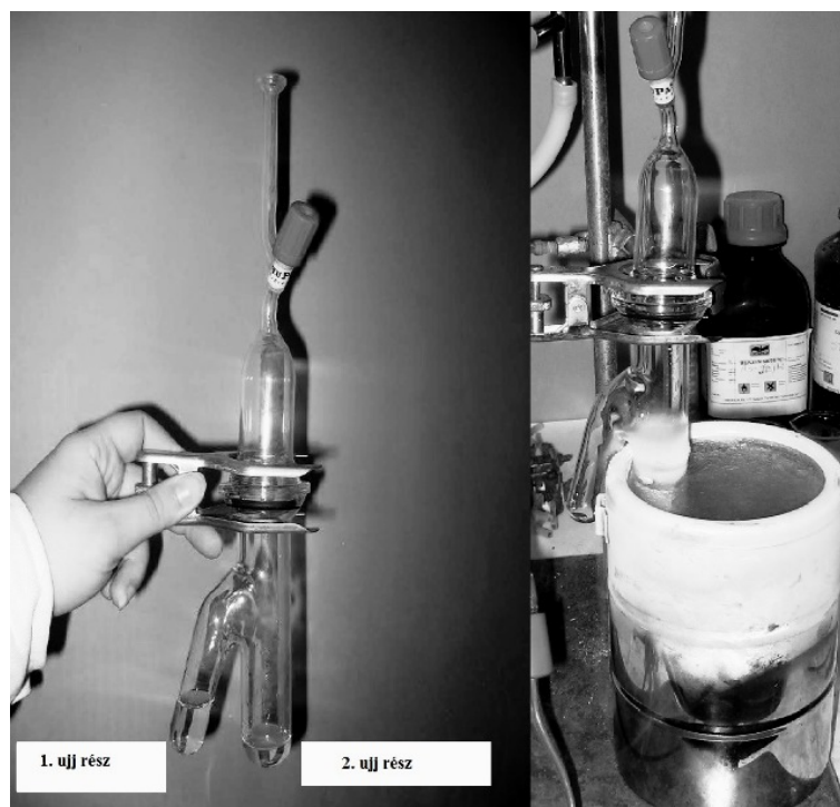
1. ábra: Az elválasztásnál alkalmazott speciális üvegedény
