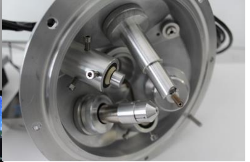
2. ábra: A hordozható röntgen-spektrométer külső felépítése és belső szerkezeti kialakítása a röntgenső és a detektor kollimátoraival, a pozicionáló lézerekkel és egy opcionálisan hozzáadható Raman-érzékelővel.
