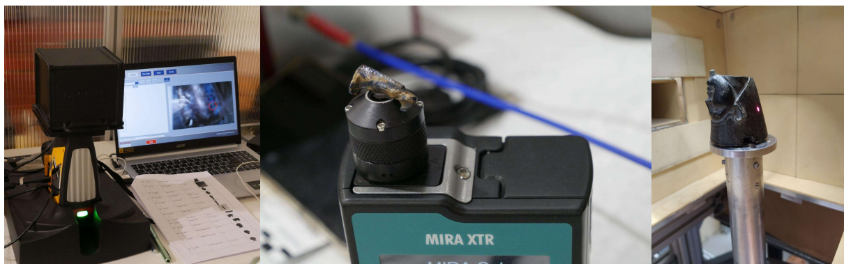
2. a-c. ábra: A mérőberendezések működés közben: a) kézi XRF, b) Raman, c) PGAA (NIPS-NORMA mérőhely)
