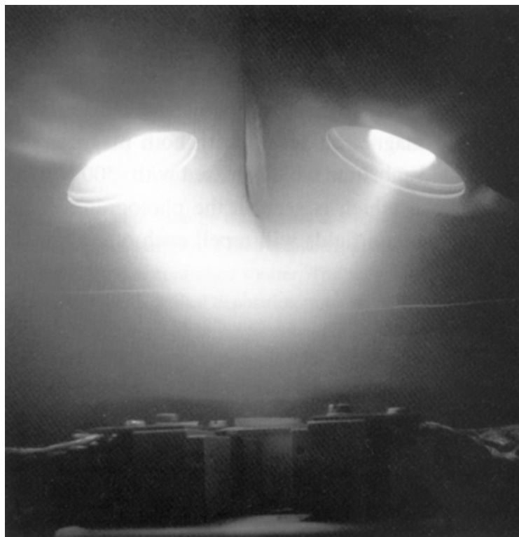
1.1 Ábra Csatolt mágneses terű magnetronok. A plazma kiterjed a két magnetron közötti térre.
